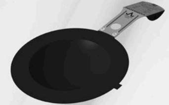
Обращены к рабочей среде выпуклой поверхностью купола и работают на потерю устойчивости. Мембраны хлопающие устойчивы к воздействию вакуумметрического давления и не нуждаются в противовакуумных опорах.
